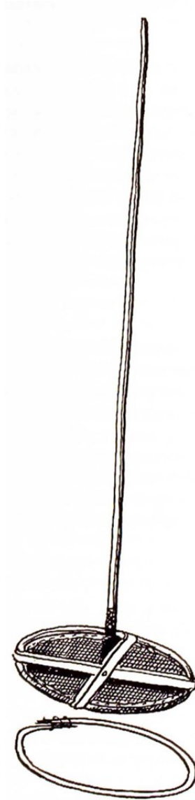
Abb. 20: Darstellung eines „Má Chadlo“. Auf einem langen Stil befestigte man ein Weiden-Reif, auf dem ein dickes Leinengewebe genäht war. Dieses Gerät wurde verwendet, um das Kohlendioxid aus der Grube entfernen. (Kunz 2004, Abb. 51)
